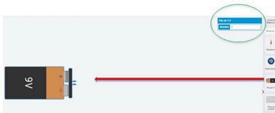
Podemos girar un componente, para ello seleccionamos la batería (se bordea en color azul) y con la tecla R del teclado la giramos. Al estar seleccionado un componente aparece un cuadro (resaltado dentro de un óvalo en la imagen superior) donde podemos editar algunas de sus características.
