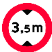
C42. Vognhøjde tavlen forbyder kørsel med køretøjer, hvis højde inklusive læs er større end den angivne.
