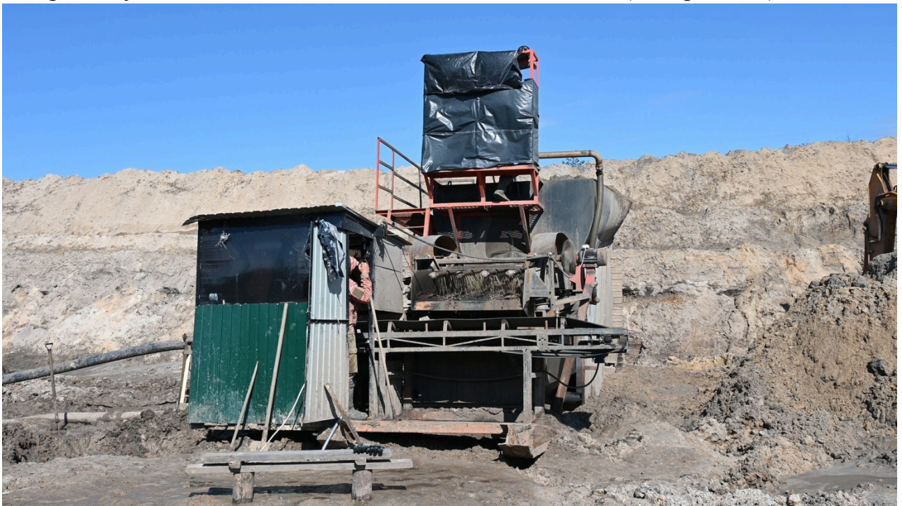
Рисунок 7.1 – ППУ ПМ-20 під час промивки валових проб
