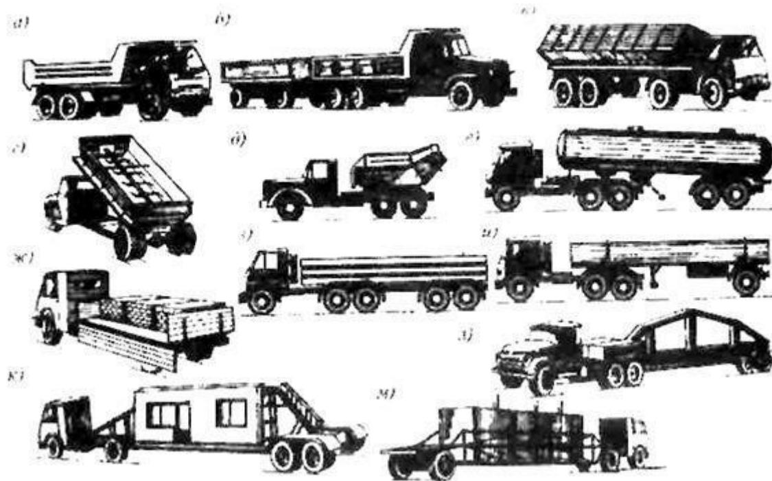
а – автосамосвал; б – автопоезд с самосвальными прицепами; в – автомобиль с увеличенной вместимостью кузова; г – авторастворовоз; д – автобетоновоз; е – битумовоз; ж – бортовой автомобиль для доставки кирпича; з – плитовоз; и – балковоз; к – панелевоз; л – фермовоз; м – сантех- кабиновоз
