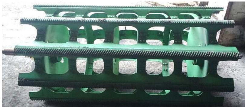
Рис. 8.8. Загальний вигляд молотильного барабану
