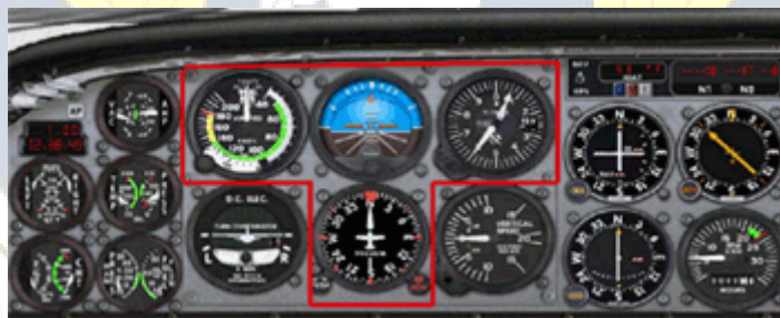
Figura 1: En Flight Simulator, el panel del Cessna Skylane, marcado en rojo los instrumentos de la T básica.
