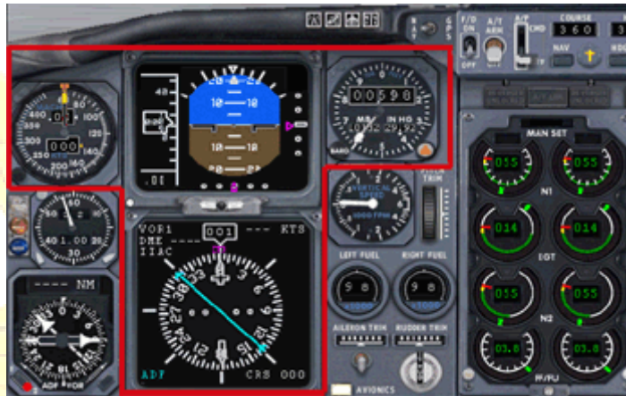
Figura 2: En Flight Simulator, el panel del Boeing 737-400, marcado en rojo los instrumentos de la T básica. Nótese la distribución similar con la del Cessna
