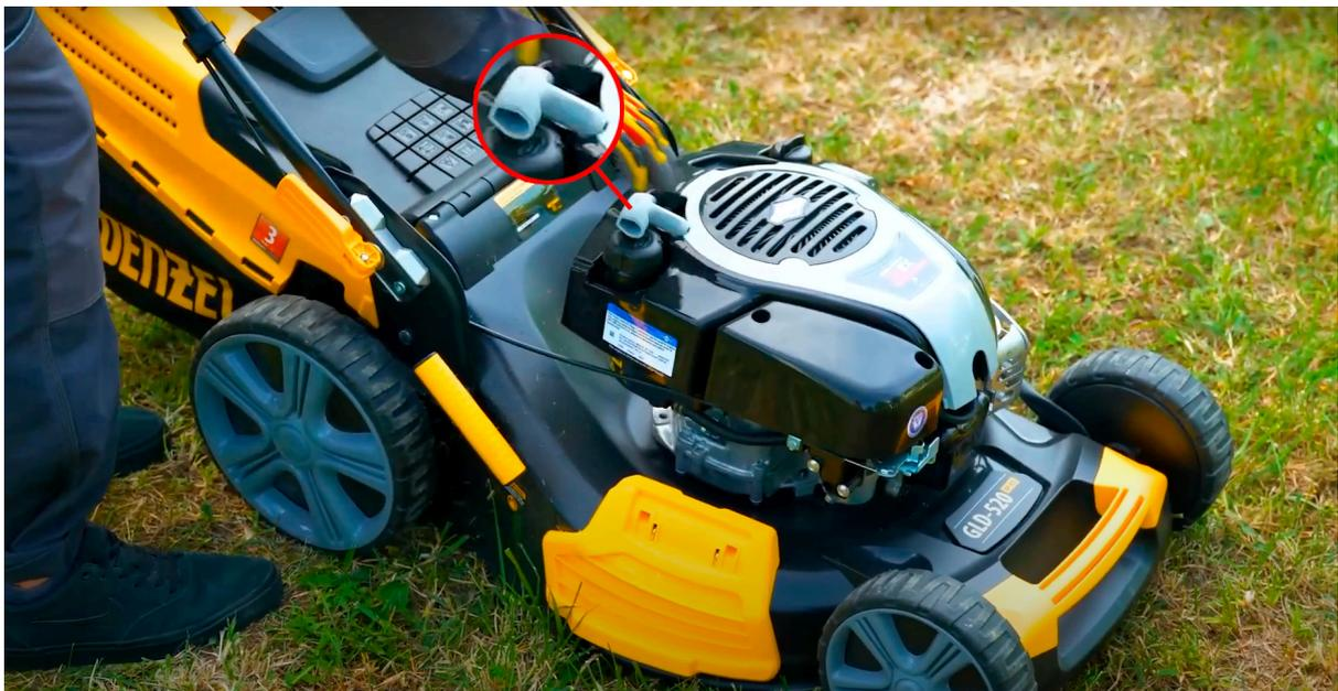
Зажмите рычаг привода ножа и медленно вытащите шнур ручного стартера, пока не почувствуете сопротивление. После этого быстро потяните его «на себя». Повторите этот процесс несколько раз.
