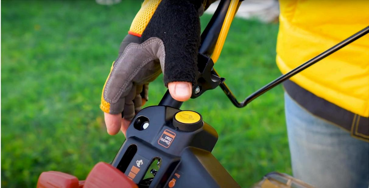
Некоторые модели снабжены электростартером. Для запуска с его помощью установите аккумулятор Denzel, зажмите рычаг привода ножа, нажмите кнопку старта. АКБ приобретается дополнительно.
