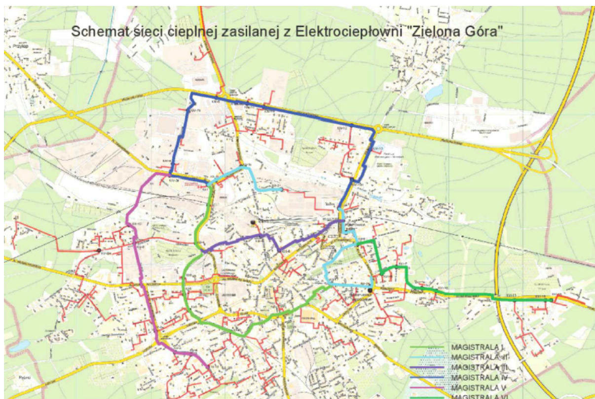
Rysunek 7. Schemat sieci ciepłej zasilanej z EC Zielona Góra S.A. źródło: Elektrociepłownia Zielona Góra S.A.
