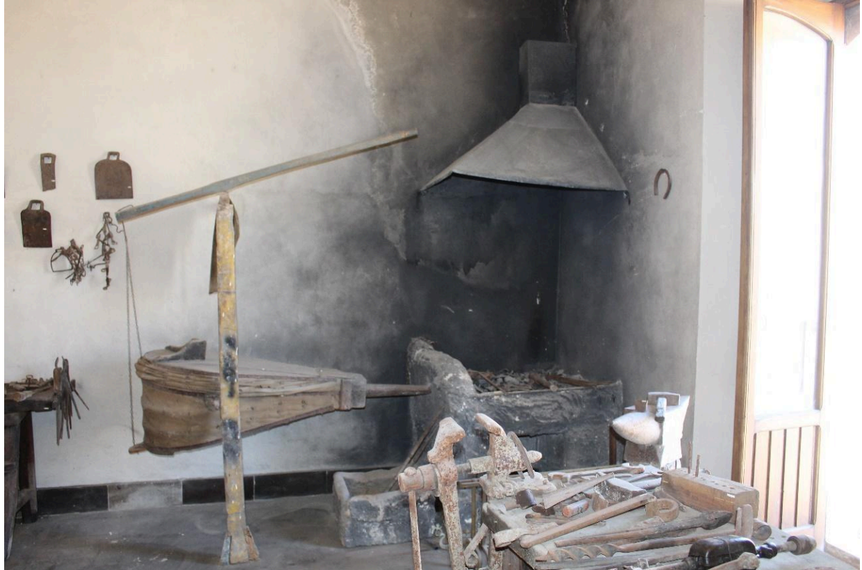
Firraru e ferrasceccchi _Fabbro ferraio e maniscalco particolare della forgia a mantice
