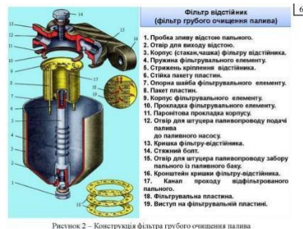
Рисунок 2 – Конструкція фільтра грубої очистки палива
