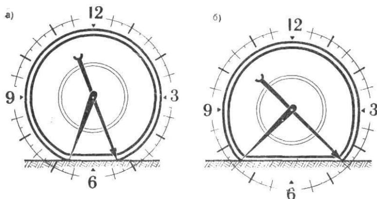
Рис. 9. Схема влияния деформации шины на время уплотнения грунта (условно).
