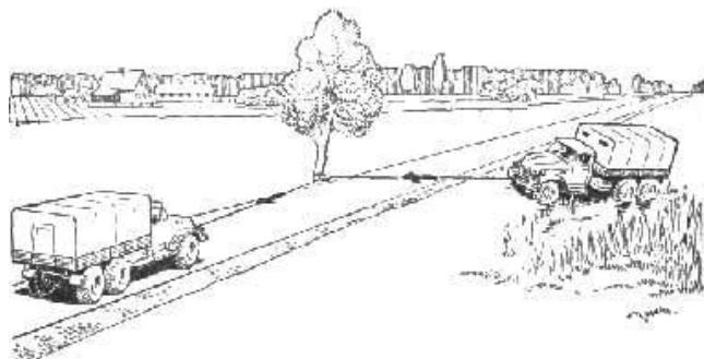
Рис. 17. Изменение направления тяги с помощью неподвижного блока
