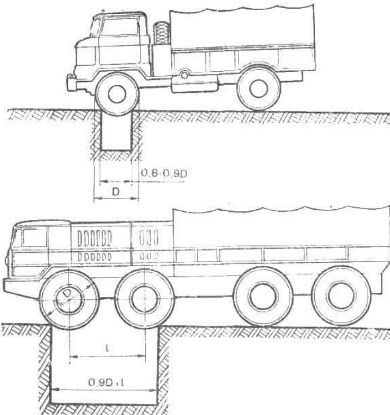
Рис. 2. Влияние схемы автомобиля на его способность преодолевать глубокие канавы с крутymi стенками
