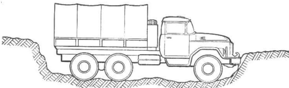
Рис. 23. Положение автомобиля «в распор»
