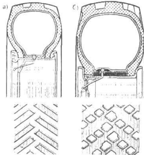
Рис. 6. Сечение шины и ее рисунок протектора:
