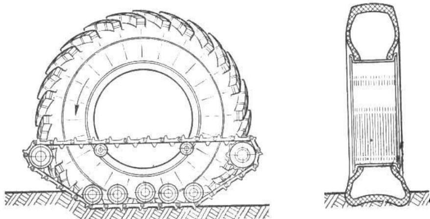
Рис. 7. Характер взаимодействия деформированной шины с грунтом 20
