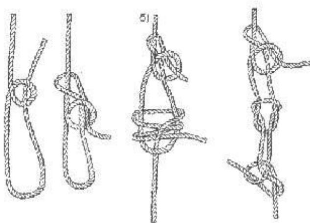
Рис. 21. Связывание тросов в случае их обрыва:
