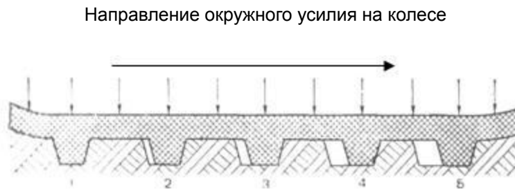
Рис.10. Схема влияния времени нахождения грунтозацепов в контакте с грунтом на величину передаваемой ими тяги
