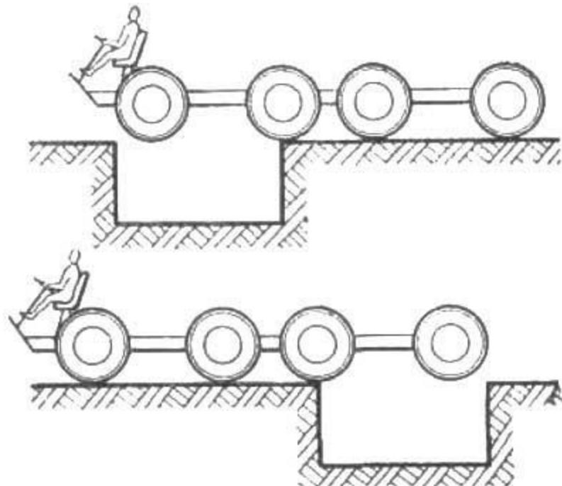
Рис. 25. Схема преодоления рва четырехосным автомобилем.
