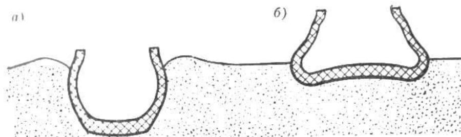
Рис. 8. Сечение колеи и характер деформации грунта (сухой песок) колесом автомобиля:
