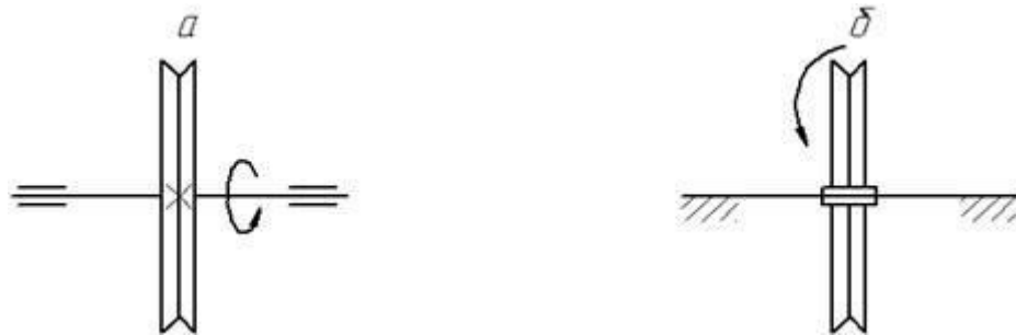
Рис. 9.4. Схеми осей за можливістю обертання
