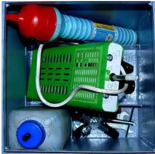
Рис. 3.141. Комплект Е412 для обслуговування стартерних акумуляторних батарей
