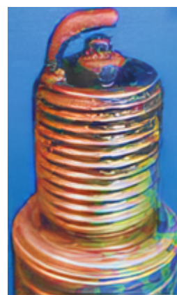
Рис. 3.128. Вигляд свічок запалювання у разі їх несправності
