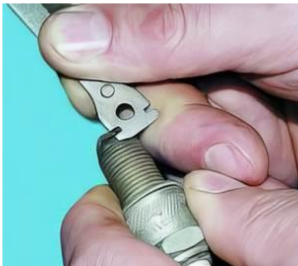
Рис. 3.133. Регулювання зазору між електродами свічки запалювання за допомогою спеціального ключа
