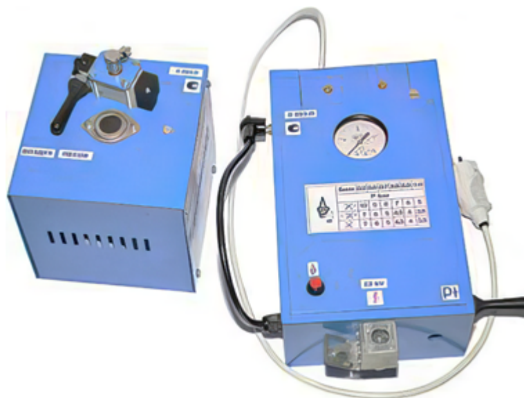
Рис. 3.152. Комплект приладів для перевірки свічок запалювання Е203
