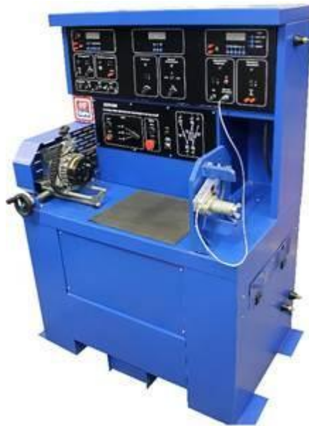
Рис. 3.149. Стенд E242 для перевірки технічного стану приладів системи електрообладнання
