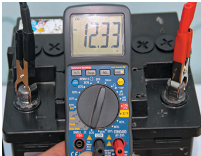
Рис. 3.110. Вимірювання електрорушійної сили акумуляторної батареї за допомогою мультиметра
