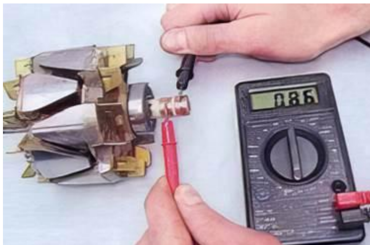
Рис. 3.116. Перевірка обмотки збудження генератора на обрив
