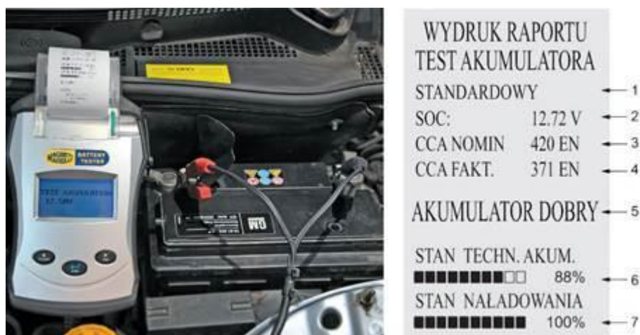
Рис. 3.113. Оцінка технічного стану акумуляторної батареї за допомогою тестера провідності:
