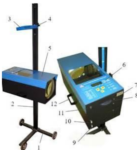
Рис. 3.154. Прилад для перевірки і регулювання променю світла фар моделі ОПК:
