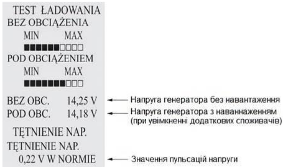
Рис. 3.123. Приклад результату оцінки технічного стану, що одержаний за допомогою тестера провідності (рис. 3.113)
