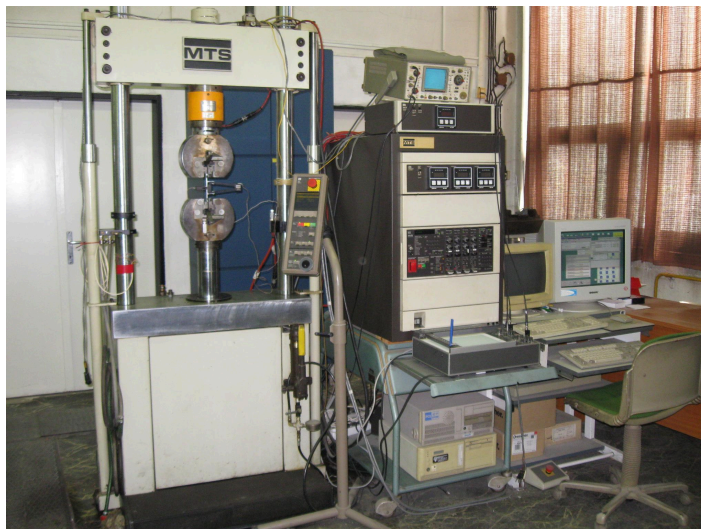
2. ábra. MTS elektrohidraulikus anyagvizsgáló berendezés
