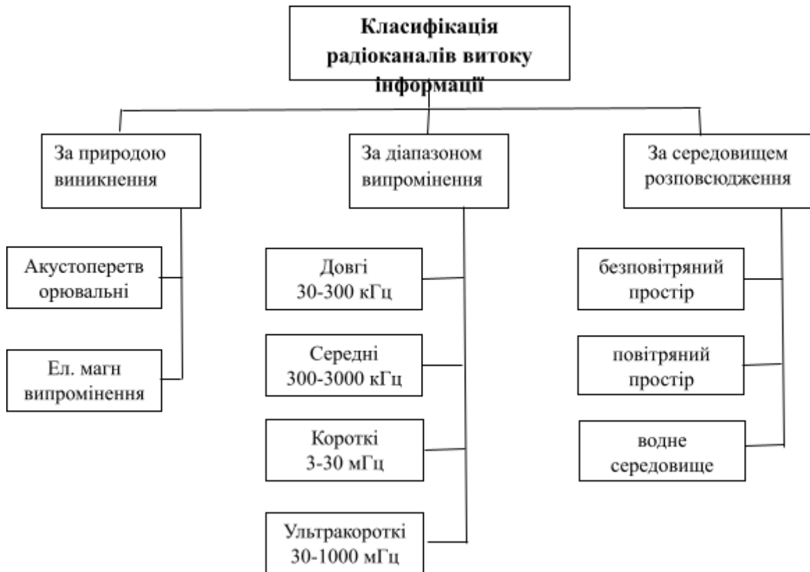
Рис. 1.3 Класифікація радіоканалів витоку інформації
