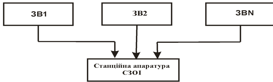
Рис. 2.11 Радіальне (променеве) безконцентраторне з'єднання станційної апаратури із ЗВ
