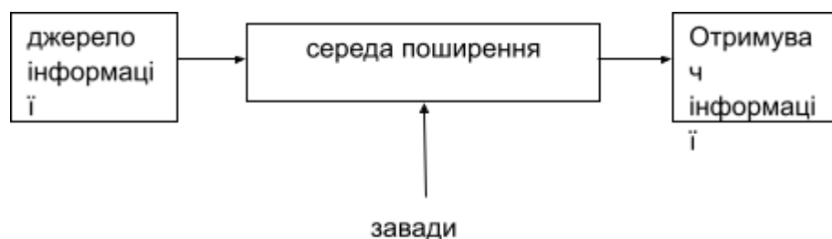
Рис. 1.2 Склад технічного каналу витоку інформації
