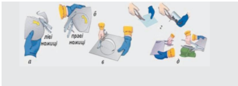
Рис. 2 Прийоми розрізання металу ручними ножицями: а – розрізання металу лівими ножицями, б – розрізання металу правими ножицями, в, г – вирізання отвору по розмічальних рисках; д – різання листової заготовки на вузькі смуги
