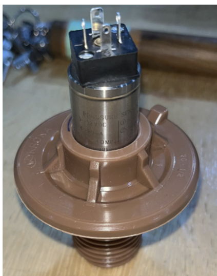
Figura 3 - Acoplamento do sensor de pressão no flange
