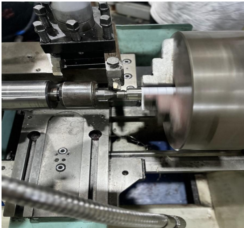
Figura 2 - Ajuste do sensor de pressão por torneamento.
