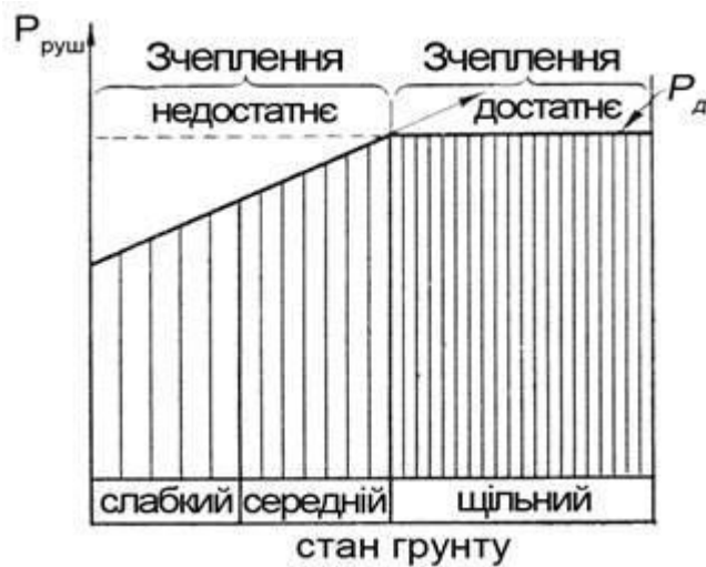
Рис. 1.3.3. Залежність рушійної сили трактора від стану ґрунту
