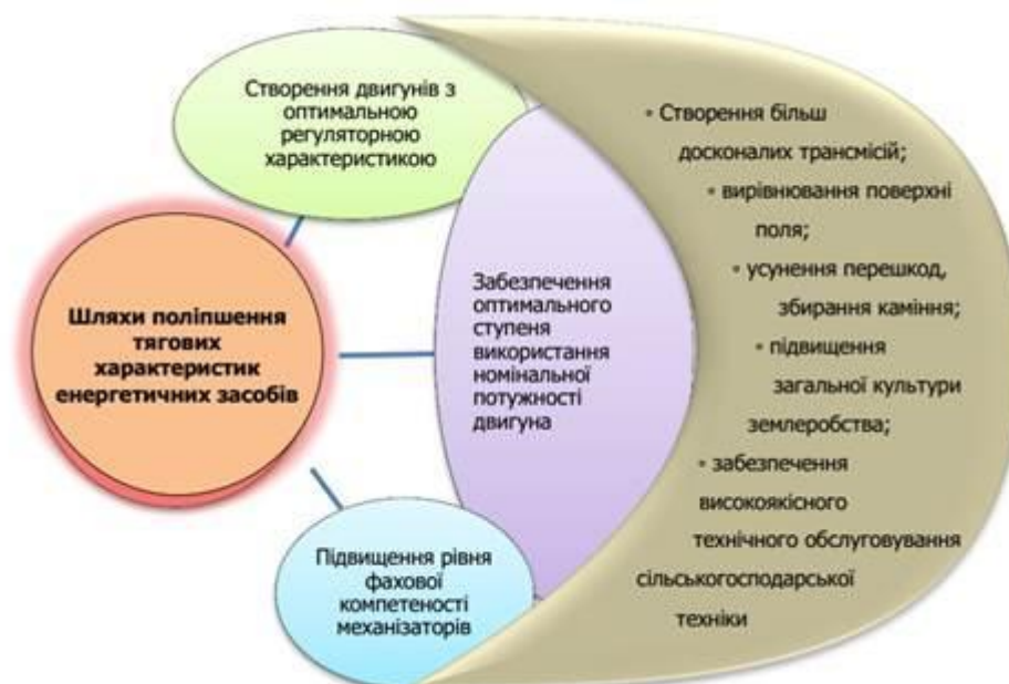
Рис. 1.3.5. Шляхи поліпшення тягово-зчіпних властивостей трактора
