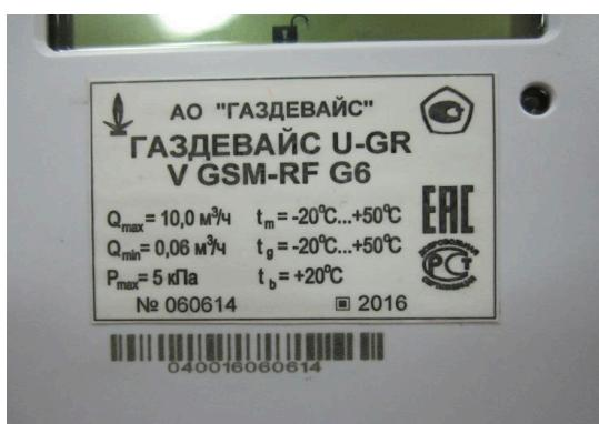
Рисунок 5 – Маркировка счетчика газа
