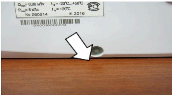
Рисунок 6 – Место пломбирования и нанесения знака поверки
