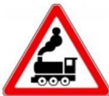
Рисунок 7 – Дорожный знак «Железнодорожный переезд без шлагбаума»
