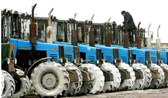
Рисунок 57. Загальний вигляд довгострокового зберігання тракторів відкритим способом.
