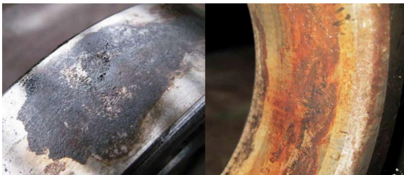
Рисунок 4.4 – Пошкодження деталей в результаті фреттінг-корозії
