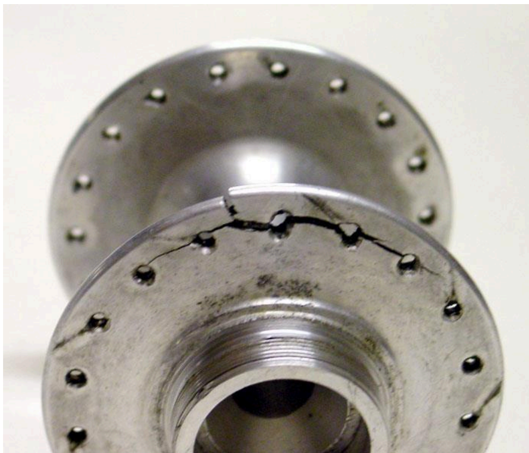
Рисунок 4.3 – Пошкодження деталі в результаті втомного зношування
