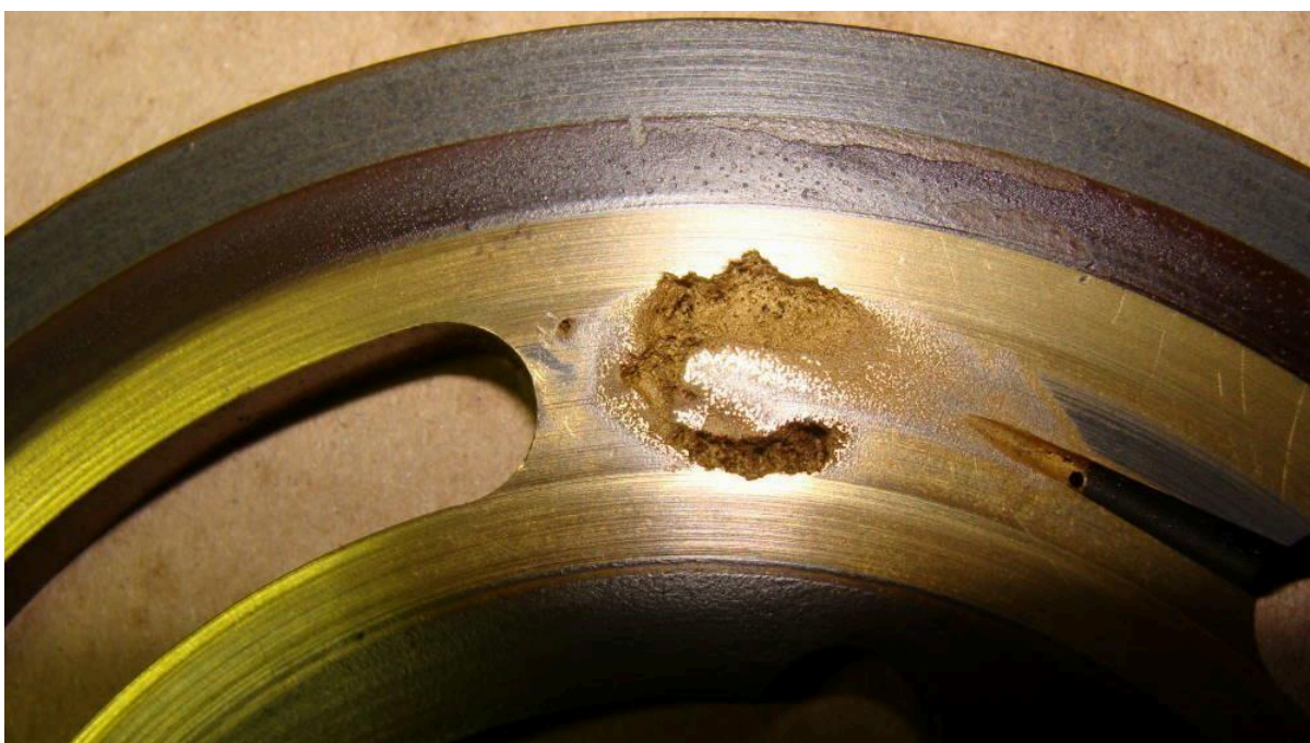
Рисунок 4.2 – Пошкодження пластини клапана аксіально-поршневого гідронасоса в результаті кавітаційного зношування
