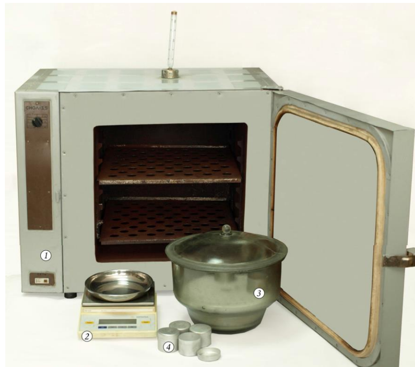
Рис.1. Обладнання для проведення досліду по визначенню вологості ґрунту: сушильна шафа (1), технічні ваги (2), ексікатор (3), алюмінієві бокси, пронумеровані (4).
