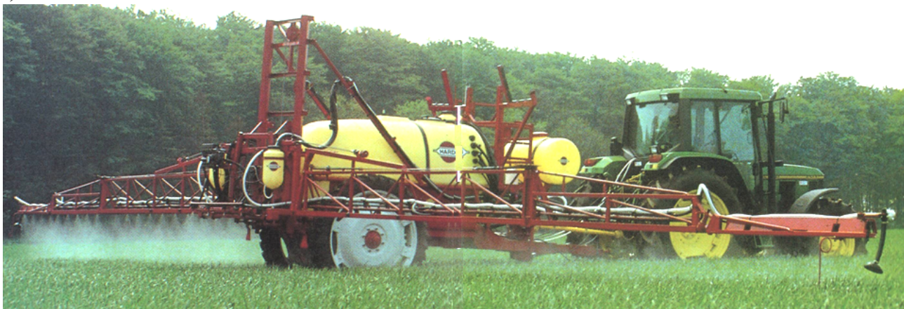
Рис.3. Причіпний обприскувач ТУ (HARDI, Данія)
