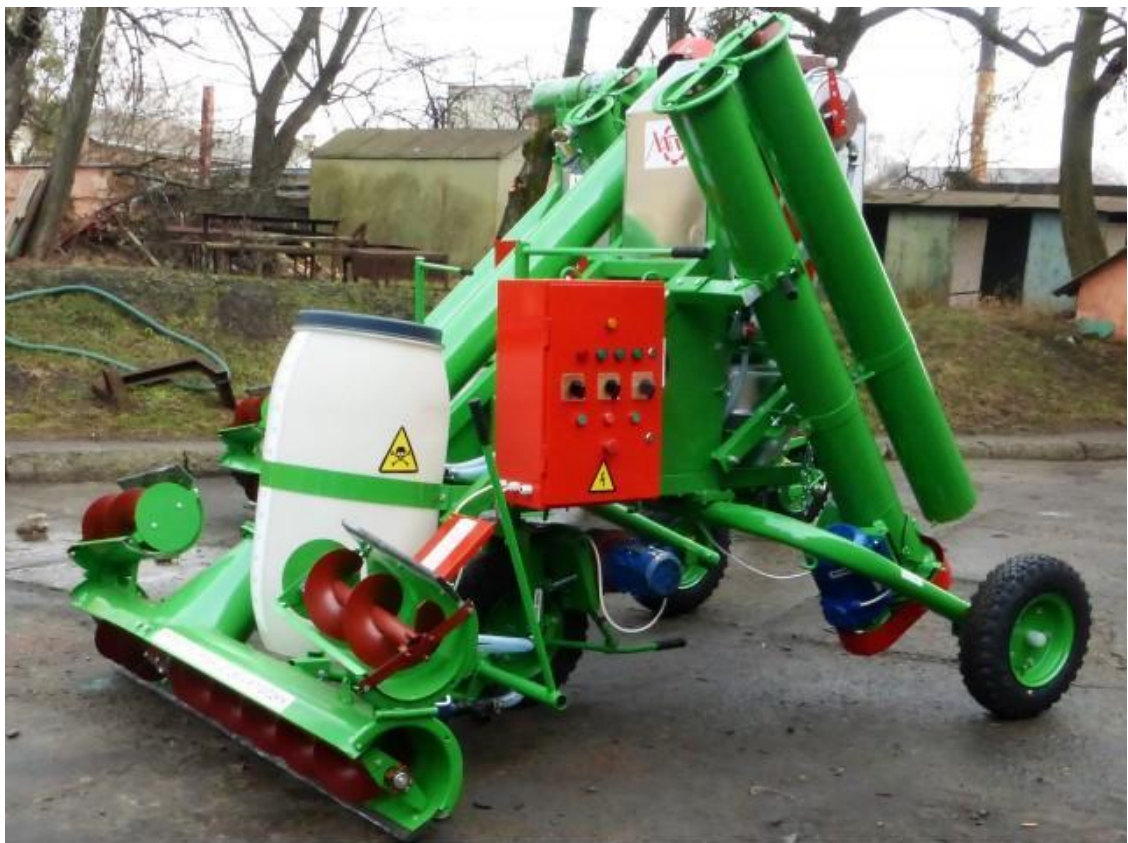
Рис.2. Камерний протруювач насіння ПК-20
