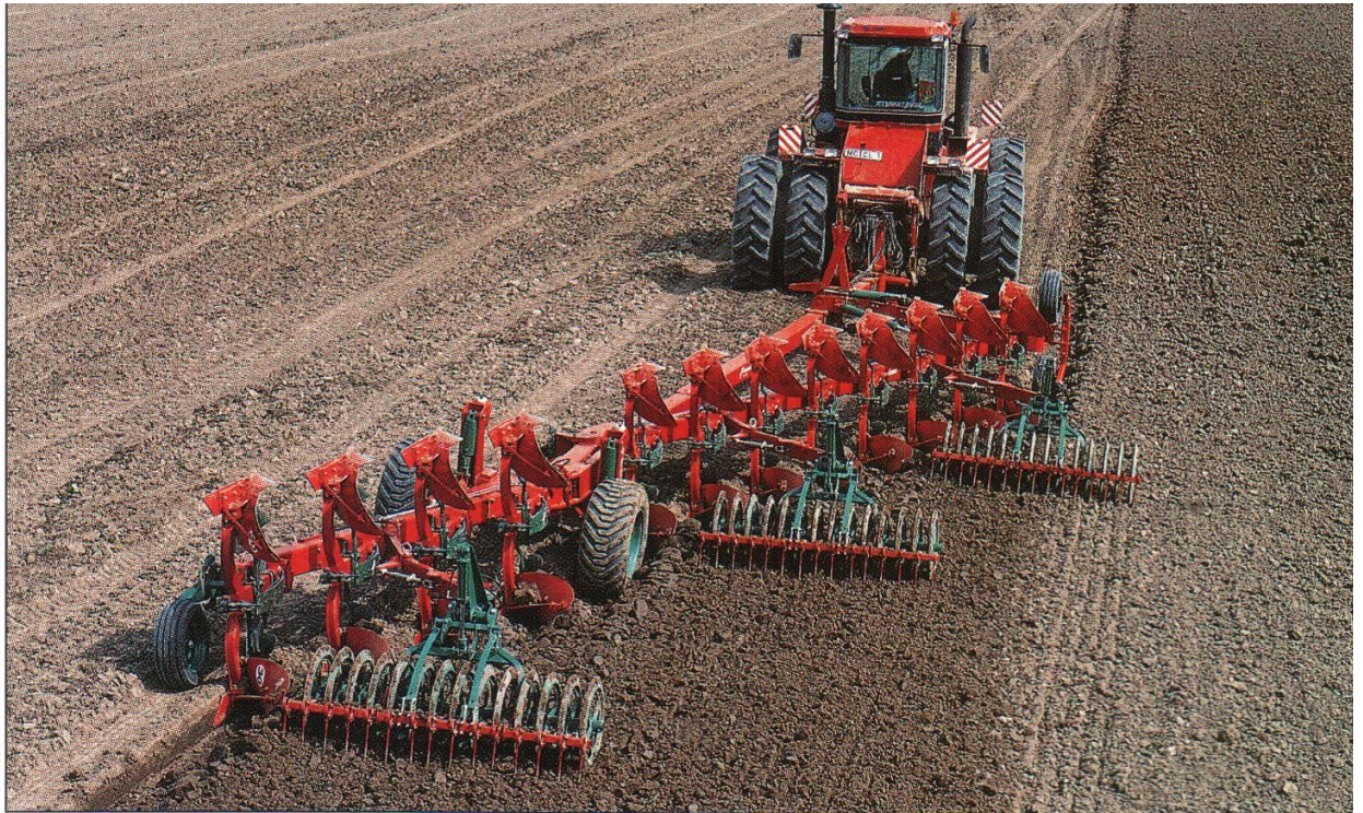
Рис. 9. 12-ти корпусний оборотний плуг PX 100 з системою „Рактомат” KVERNELAND (Норвегія)
