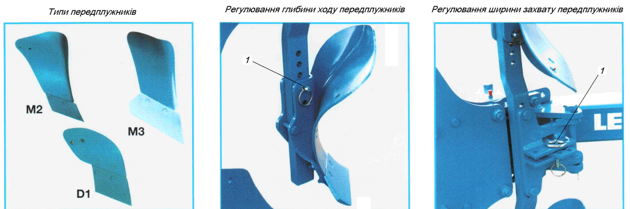
Рис. 11. Типи передплужників компанії LEMKEN та регулювання їх
