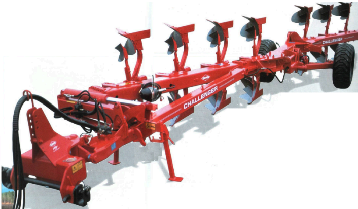
Рис. 21. Причипний оборотний семикорпусний плуг CHALLENGER з шириною захвату корпусу 30...50 см
