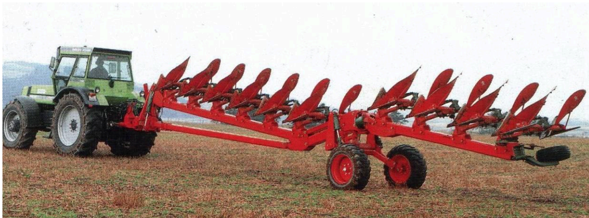
Рис. 3. Оборотний 10-ти корпусний напівначіпний плуг PX-100 KVERNELAND в транспортному положенні
