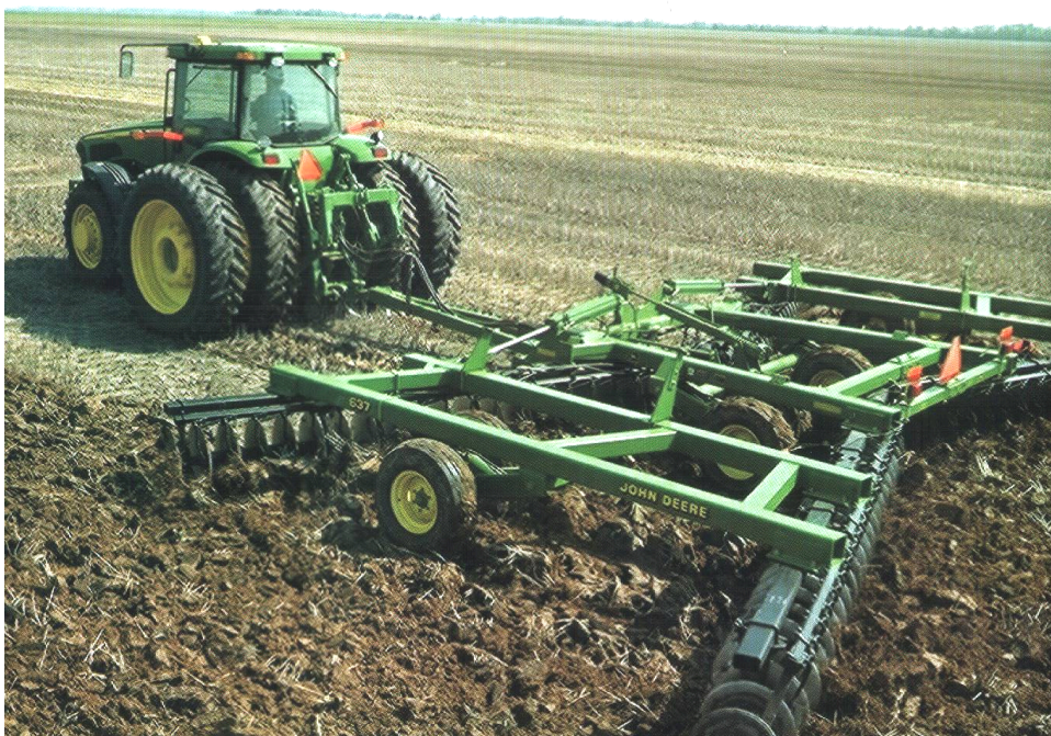
Рис. 26. Дискова борона JOHN DEERE шириною захвату 6,6 м
