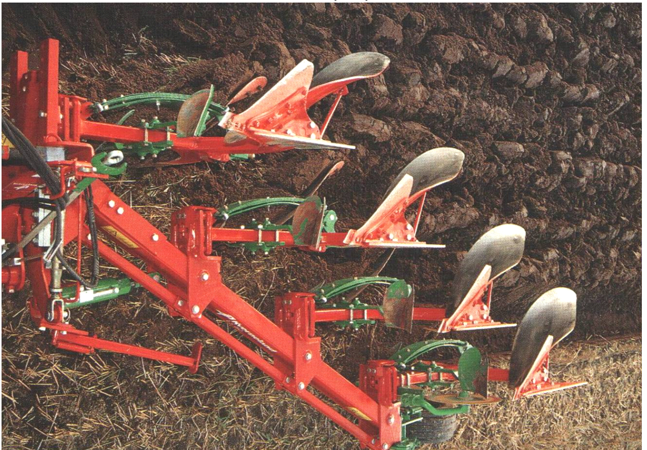
Рис. 6. Система Auto-Reset (автоповернення) компанії KVERNELAND на оборотному плузі
