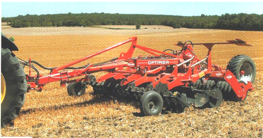
Рис.23. Дисковий луцильник OPTIMER 301 шириною захвату 4 м
