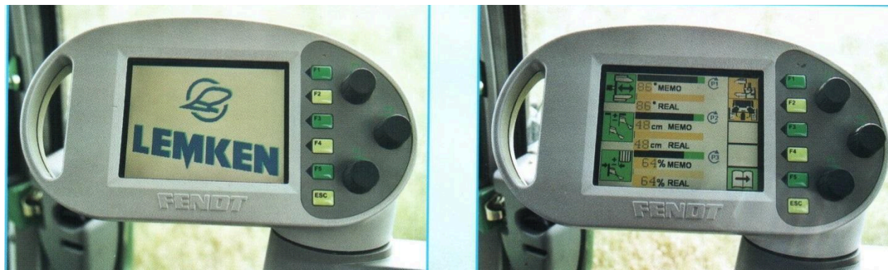
Рис. 14. Бортовий комп'ютер плугів LEMKEN
