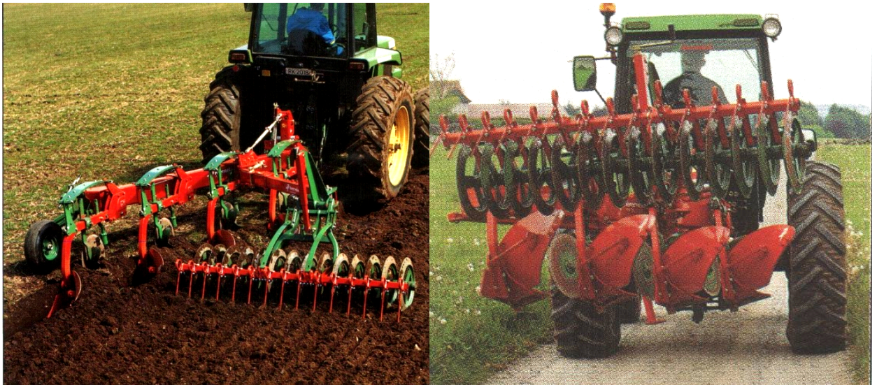
Рис. 8. Плуг з системою „Рактомат” KVERNELAND (Норвегія) в робочому (зліва) та транспортному (справа) положеннях
