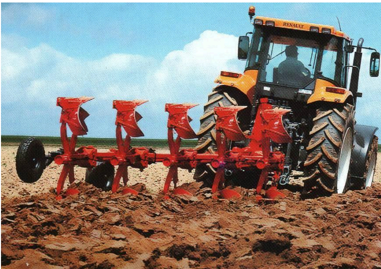
Рис. 23. Пятикорпусный оборотный начипный плуг MASTER шириною захвату корпуса 35, 40 і 45 см
