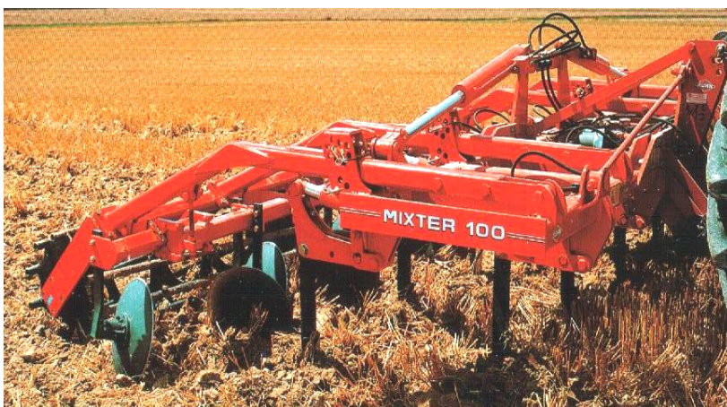
Рис. 21. Стерньовий культиватор MIXTER 100 шириною захвату 6 м
