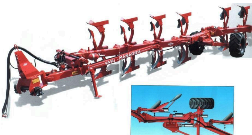
Рис. 20. Семикорпусный оборотный напівначипний плуг VARI – MANAGER з
