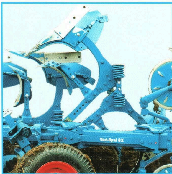
Рис. 12. Автоматичний гідравлічний (зліва) та пружинний (справа) механізм захисту від наїзду на перешкоди
