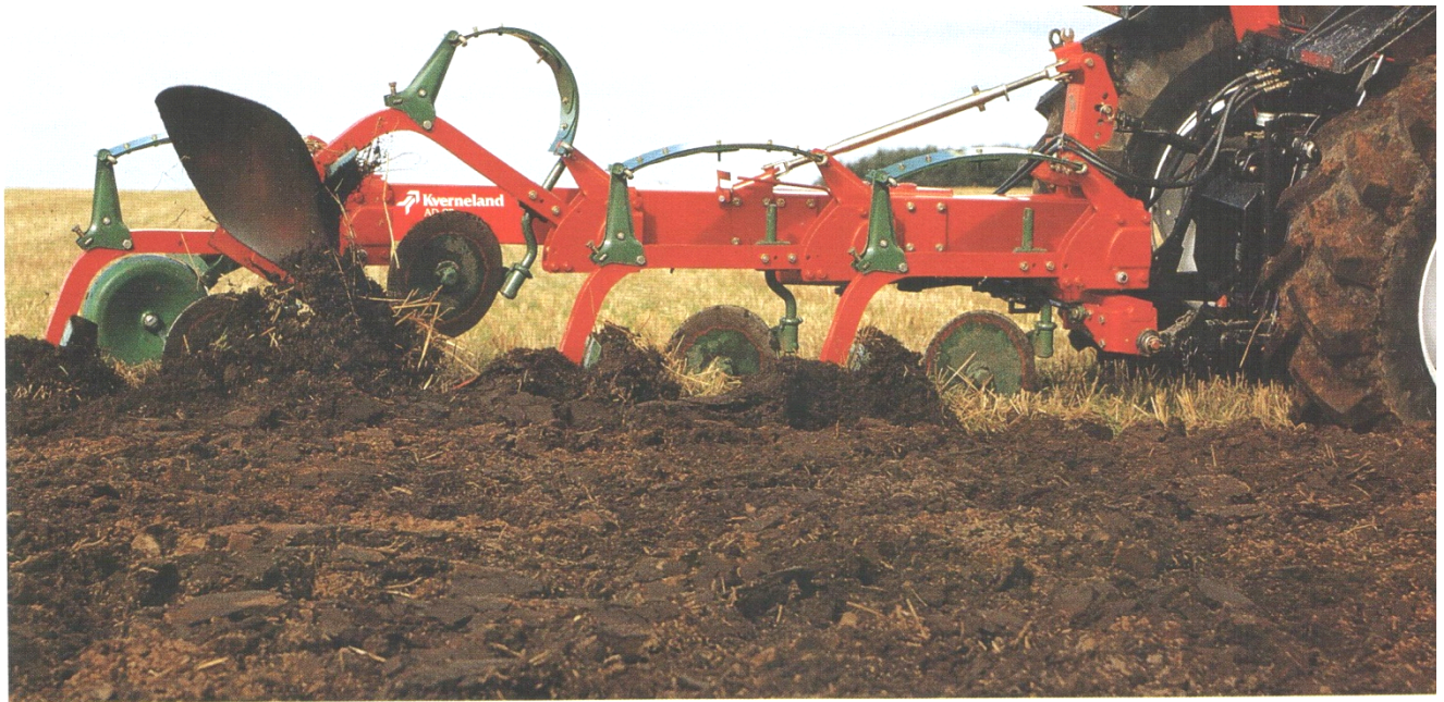
Рис. 5. Система Auto-Reset (автоповернення) компанії KVERNELAND на звичайному плузі
