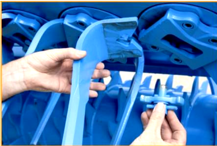
Рис. 18. Запатентована система кріплення зубів борони ЦИРКОН.
