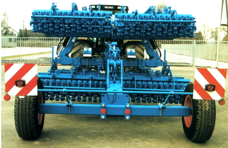
Рис. 20. Комбінований ґрунтообробний агрегат К-600А (компактор) компанії LEMKEN (Німеччина) в транспортному положенні
