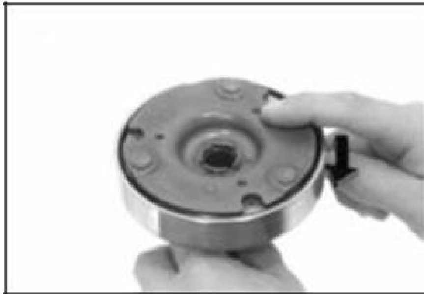
Gambar 26. Pemeriksaan kopling sentrifugal
