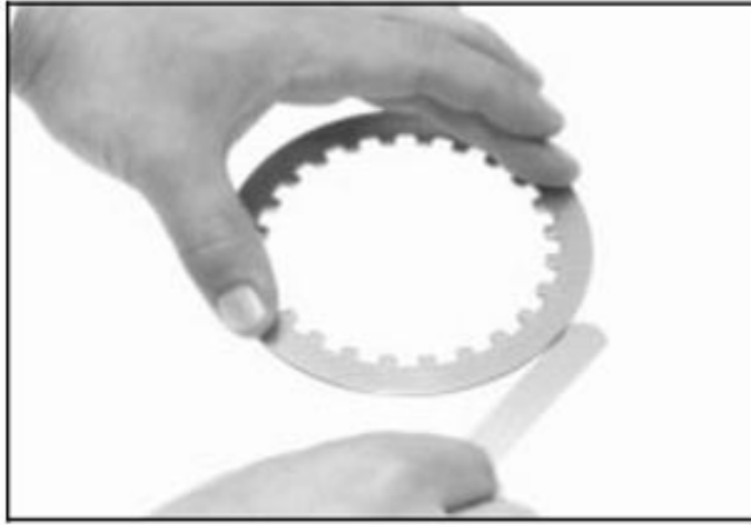
Gambar 24. Mengukur kerataan kanvas kopling
