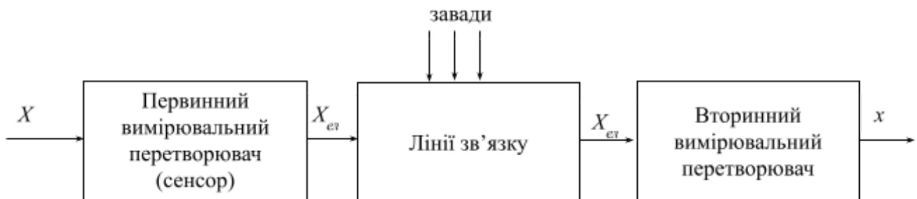
Рисунок 3.1 – Узагальнена структурна схема електричного приладу для вимірювання неелектричних величин
