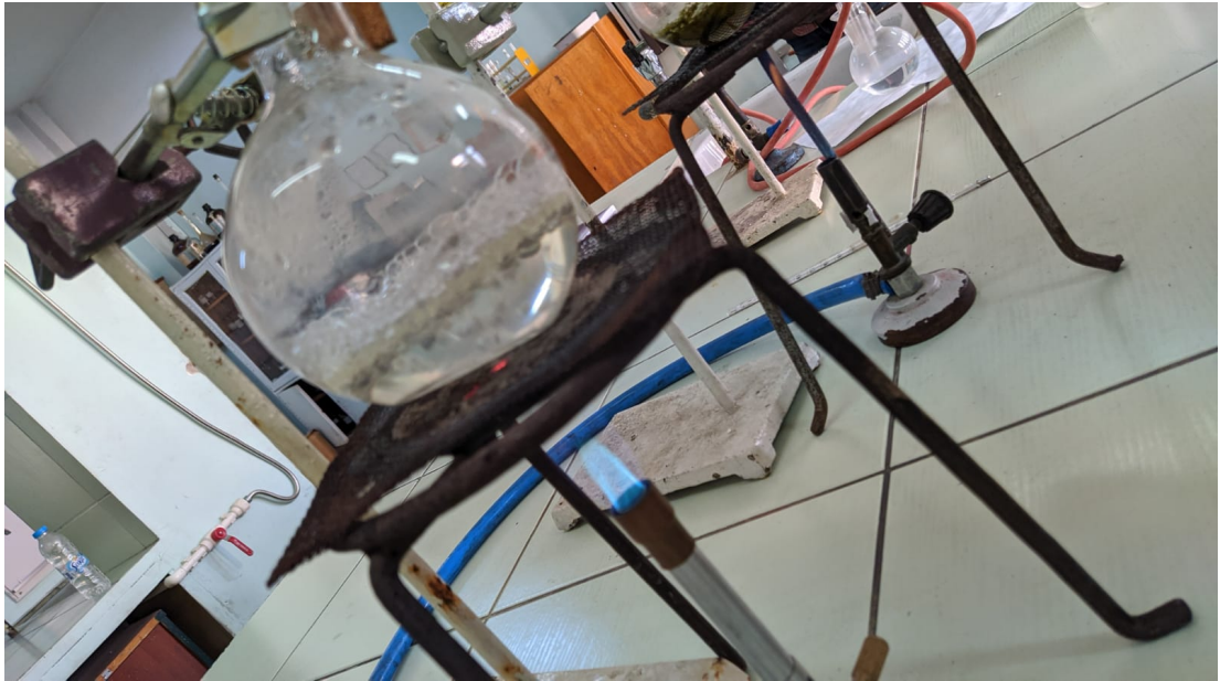
Şekil 6. Distilasyon düzeneğinin 1. cam balonunda saf suyun kaynatılması.
