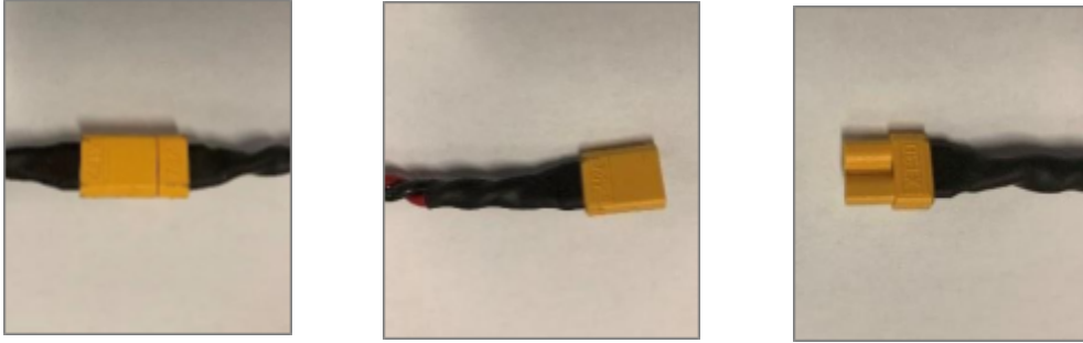
Şekil 31: XT30 Konnektörler (Erkek ve Dişi)
