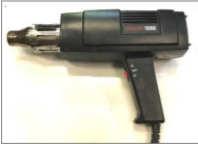
Şekil 9: Scrink sargı yalıtımı için Isı Tabancası
