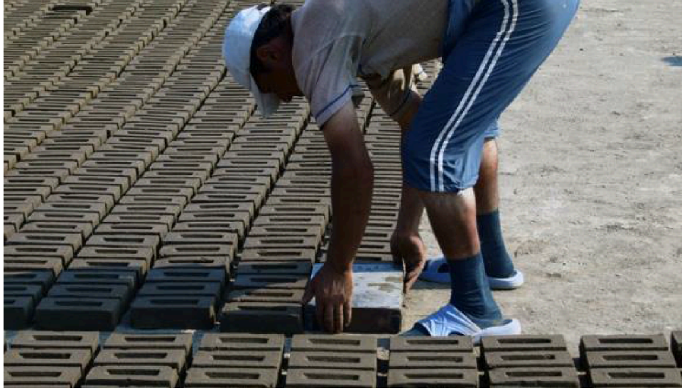
Şekil 11. Tuğlaların Kurutma Alanına Dizilmesi.
