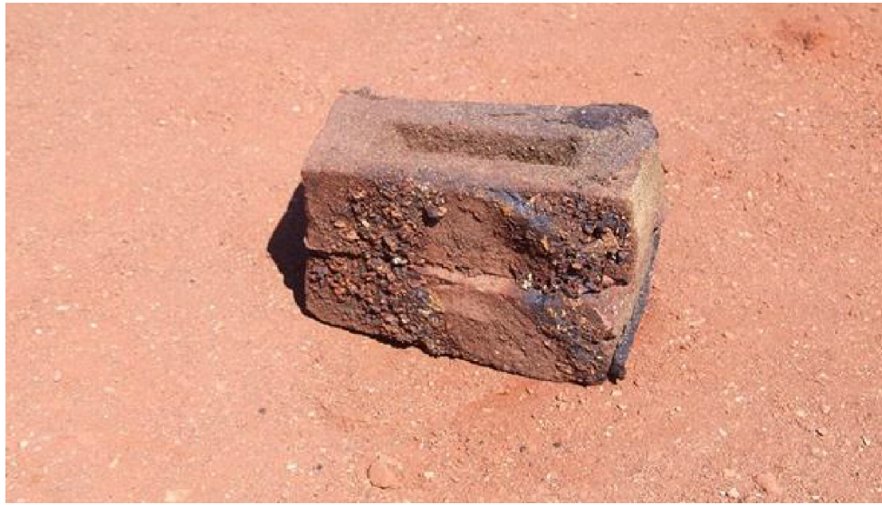
Şekil 24. Fazla Isı Sebebi ile Zinterleşmiş Tuğlalar.
