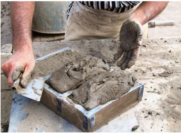
Şekil 10. Kalıba Çamur Basılması.
