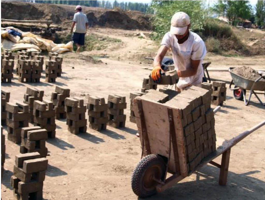
Şekil 13. Kuru Tuğlaların Taşınması.
