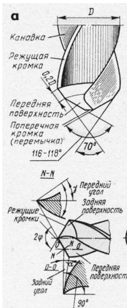
Рис. 2. Спиральні свердла( а, б), елементи свердла (в)
