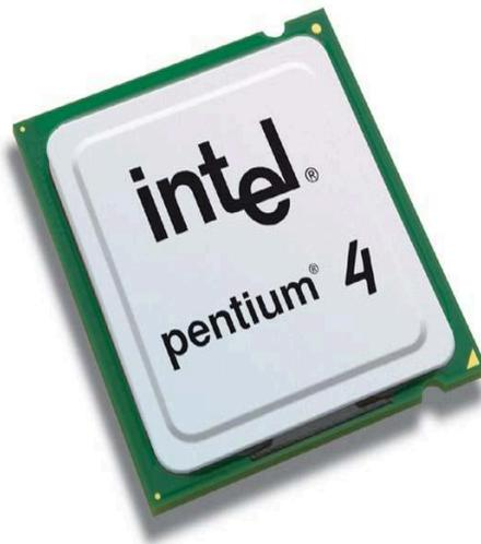
El microprocesador es un circuito integrado que contiene todos los elementos necesarios para conformar la unidad central de procesamiento, conocido como CPU (por sus siglas en inglés:
