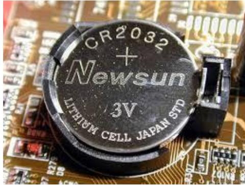
Proporciona la electricidad necesaria para operar el circuito constantemente y que este último no se apague perdiendo la serie de configuraciones guardadas.
