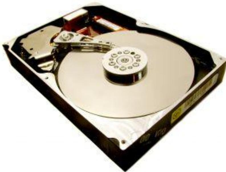
El disco duro es un dispositivo magnético que almacena todos los programas y datos de los programas y datos de la computadora. Su capacidad de almacenamiento se mide en gigabytes(GB) .Un disco duro está compuesto de numerosos discos de material sensible a los campos magnéticos, apilados unos sobre otros.
