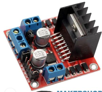
Driver motor L298N merupakan module driver motor DC yang paling banyak digunakan atau di pakai didunia elektronika yang difungsikan untuk mengontrol kecepatan serta arah perputaran motor DC.
