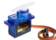
Motor servo adalah servo mekanisme *loop* tertutup yang menggunakan umpan balik posisi untuk mengontrol gerakan dan posisi akhirnya. *Input* ke kontrolnya adalah sinyal (baik analog atau [digital](#)) yang mewakili posisi yang diperintahkan untuk poros *output*.
