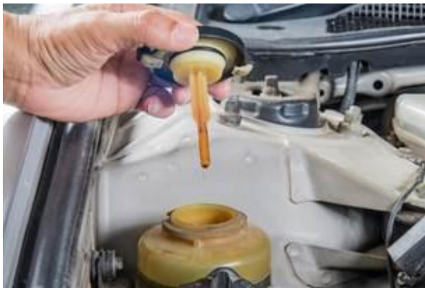
Рис. 4.104. Перевірка рівня робочої рідини та її доливання в бачок гідравлічного підсилювача рульового керування
