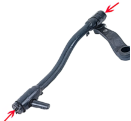
Рис. 4.105. Регулювання зазорів у шарнірах рульових тяг
