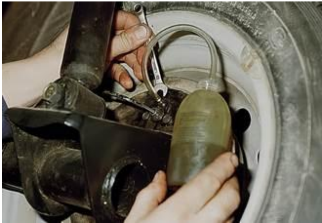
Рис. 4.110. Видалення повітря з гідравлічного приводу гальм: 1 – ключ для відкручування перепускного клапана; 2 – гумовий шланг; 3 – посудина для гальмівної рідини
