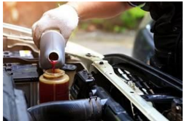
Рис. 4.104. Перевірка рівня робочої рідини та її доливання в бачок гідравлічного підсилювача рульового керування
