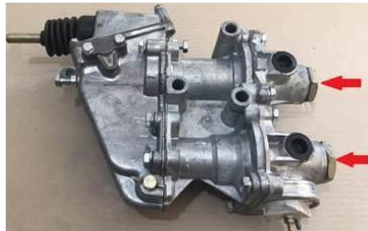
Рис. 4.118. Регулювання ходу впускного клапана гальмівного крана:
