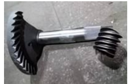
Рис. 4.96. Черв'як і зубчастий сектор з валом рульової сошки
