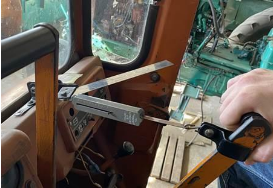
Рис. 4.91. Вимірювання зусилля на важелі керування муфтою повороту гусеничного трактора
