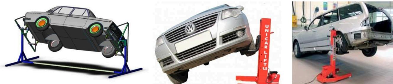
Рисунок 18 – Опрокидыватели для автомобилей
