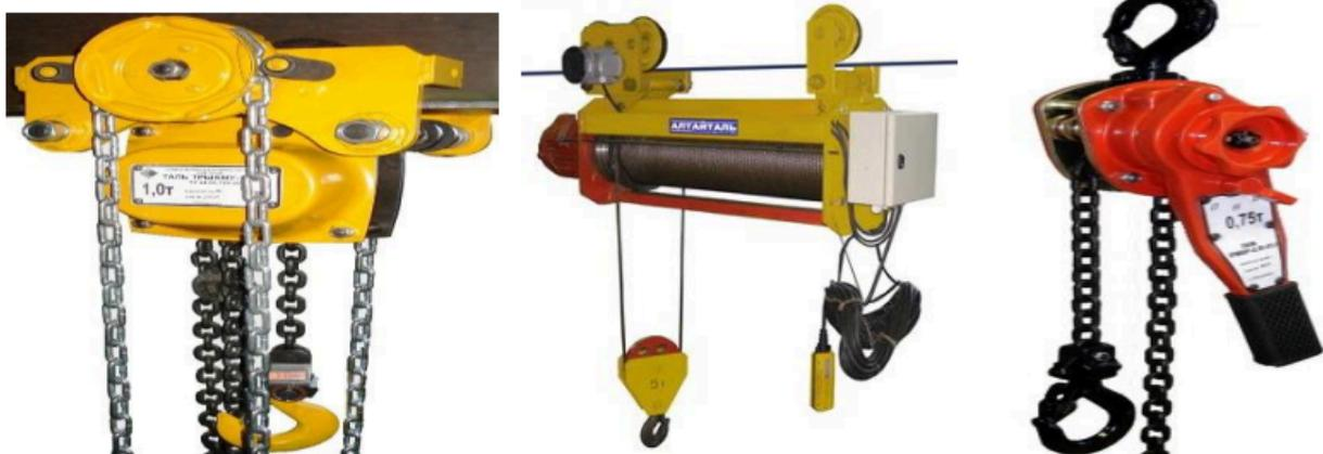
Рисунок 7 – Гаражные тали электрические передвижные
