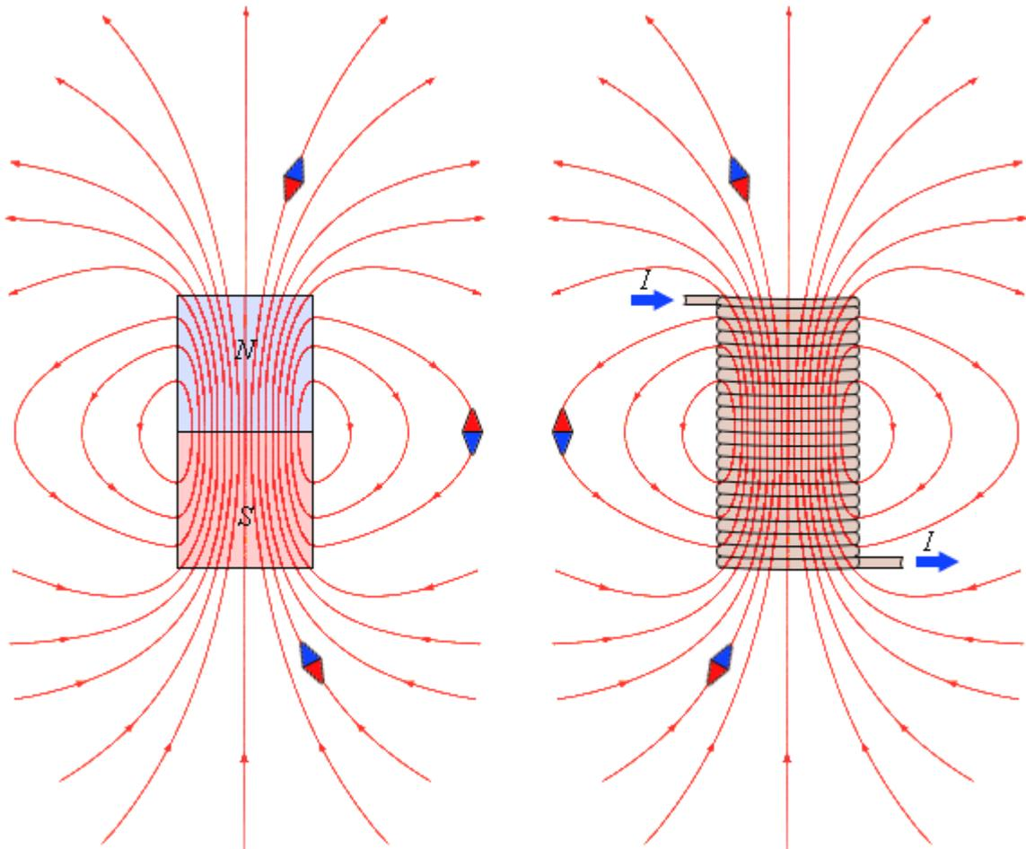
Модуль магнитной индукции определяется как отношение максимальной силы  $F_{max}$ , с которой магнитное поле действует на проводник единичной длины  $L = 1\text{ м}$ , к силе тока в проводнике:
