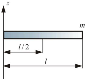
Пример: стержень массой  $m$ , длиной  $l$ , вращается вокруг оси, проходящей через конец стержня.
